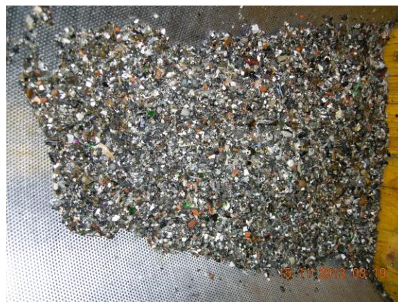
Abb. 4: Störstoffe, welche mit dem Hydrozyklon an der ARA Zirl abgetrennt wurden.
